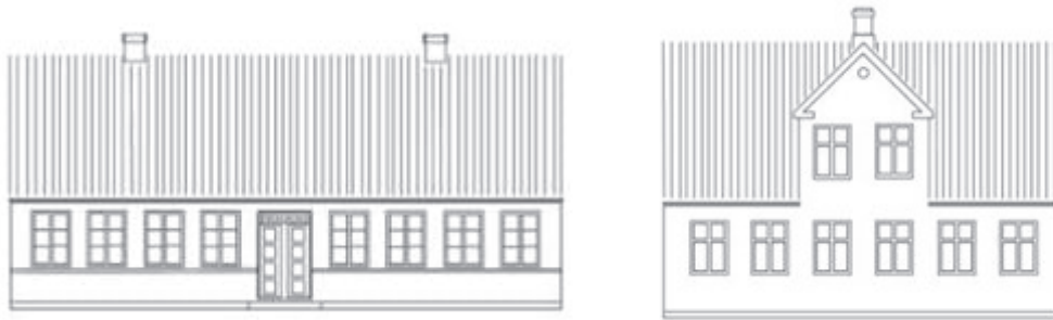
Principskitse for et fagdelt længehus (tv.) og et fagdelt byhus (th.).
