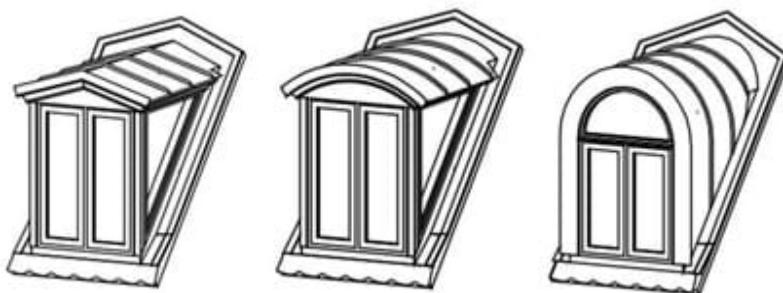
Figur nr. 11: Principskitse for kviste med saddeltag, buet- eller halvrundt tag.
